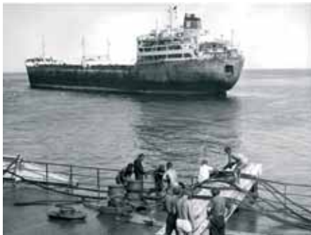
Herstellung einer Schlepp- verbindung um havariertem Schiff „MR Schwarzheide“ Foto: Jungnickel
